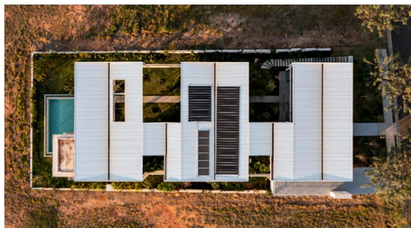
Um dos grandes diferenciais do projeto são as telhas brancas metálicas que revestem as áreas externas, atendendo a funcionalidade de proteção térmica e climática e criando um visual translúcido que remete a um conceito industrial. Para o aquecimento da água o escritório fez uso dos sistemas a gás e solar, integrados. A combinação dos dois sistemas reduz o consumo de energia, sendo uma opção sustentável.
